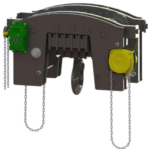
通过减速机的传动结构设计，使小车左右移动更加轻松，稳定。突破了传统大吨位小车的传动结构，减速机的传动还有自锁功能。
