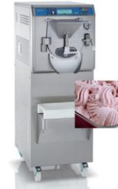
将浆料投入到冷冻缸中，经搅拌机反复摔打。浆料逐渐变成冰淇淋的过程，即为冰淇淋生产过程。
